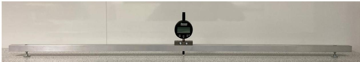
Abbildung 1: Verzugsmessvorrichtung
